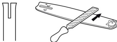
Для равномерного износа шины и продления срока ее эксплуатации переворачивайте шину каждые 8 часов работы. Это позволит равномерно распределять износ полотна. Держите паз шины и отверстие для смазки в чистоте.
