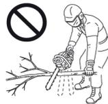
Не работайте цепной пилой, держа ее одной рукой. Последствиями работы одной рукой могут стать серьезные травмы оператора, помощников или окружающих. Для должного контроля всегда работайте цепной пилой обеими руками, одна из которых управляет выключателем. В противном случае пила может выскользнуть из рук, или ее может увести в сторону, что приведет к серьезным травмам из-за потери контроля над ней.
