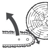
Будьте предельно внимательны и не подносите носок пильной шины до касания с предметом, это вызывает мгновенный обратный удар, при котором шина будет резко отброшена назад и вверх по направлению к оператору, в этом случае тормоз цепи автоматически активируется при
